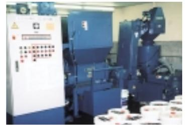
切粉処理装置。職場で発生した切粉の油分離と切断を行う
