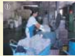
① 遠心分離機に切粉を入れ、回転させて油だけを取り出す。
