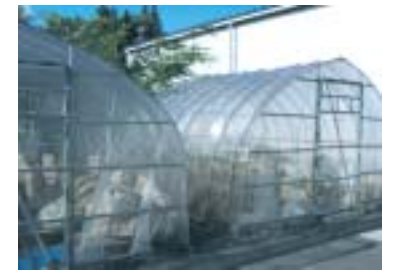
汚泥乾燥用ビニールハウス
