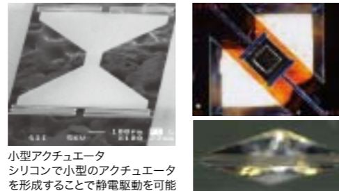
超高感度X線センサ 上:上面図、下:斜視図 薄膜(厚さ1μm)上にセンサを形成することで高感度化を実現しています。
