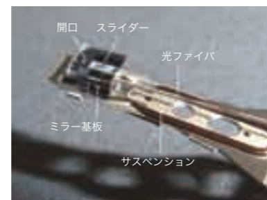
光導入部に光ファイバを利用することで薄型を実現した近接場光ヘッドをサスペンションアームに搭載したアセンブリ
