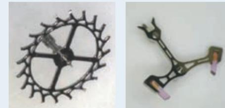
図1 UV-LIGA技術で作製したかんざし車（左）とアンクル（右）
