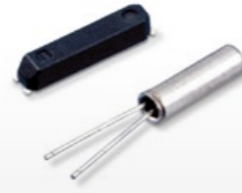
水晶振動子 フォトリソグラフィ技術により小型・高精度化を実現。低消費電力化にも貢献しています。
