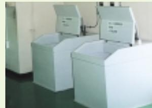
4-2 切粉投入口。2階の職場で発生した切粉を投入し、1階まで落す。
