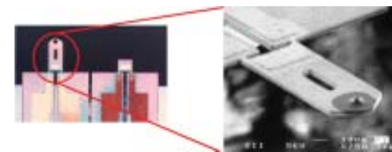
压电阻型自我检测悬臂： 应用为了扫描型探头显微镜而开发的压电阻型自我检测悬臂的传感器技术和用于巨大的高低不平的地方的微细模型形成技术，我们希望能向客户提供新的传感装置。
