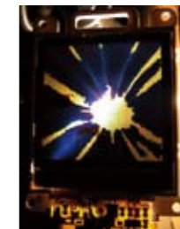
LCD 显示屏裂纹
