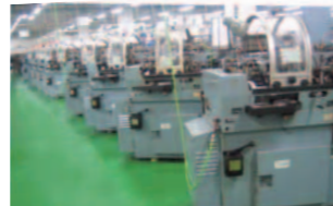
废除了油底盘的自动切削机床
