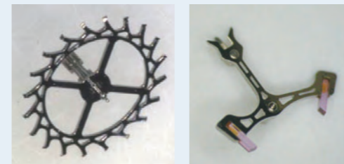
图1 运用UV-LIGA技术加工的擒纵轮（左）和擒纵叉（右）
