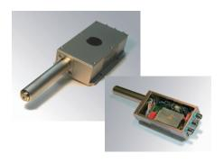
独国**KETEK社**のアナログX線測定システム **AXAS-A** は、SDD(シリコンドリフト検出器)、フィルタエレメント、プリアンプ、シェーパー、電源、測定中の温度制御機能を内蔵した最先端のシリコン放射線検出システムです。この全機能をアルミニウムハウジング(230×78×38 mm³)に統合したコンパクトなシステムは、内蔵のプリアンプで増幅、形成した信号の出力が可能です。必要なのは入力用の±12Vです。
