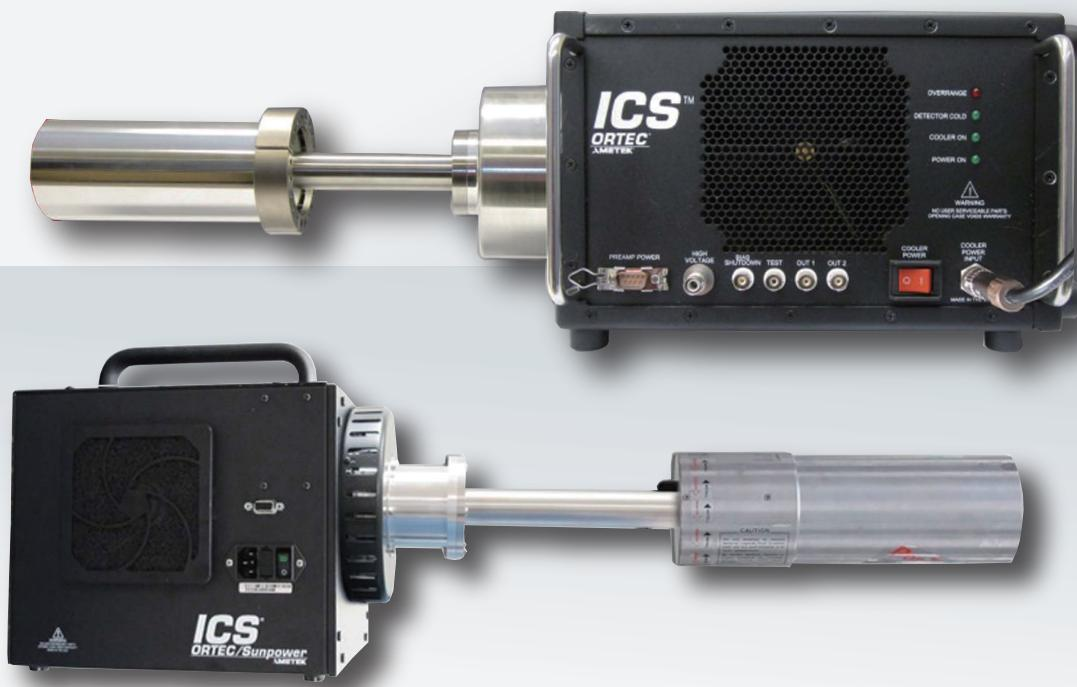
ICS (Integrated Cryocooling System) は、ORTEC の最新鋭の統合型冷却システムです。ICSによって、液体窒素でGe検出器を冷却した場合と同等な性能を提供します。ICSにはGEM, GMX, Profile型Ge検出器が使用できます。また、優れた冷却機構と強化型クライオスタッフによって、メンテナンスフリーを実現しています。
