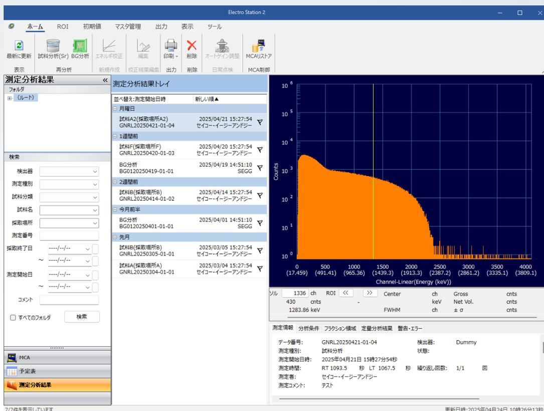
Electro Station 2は、ベータ線スペクトロメトリー法(Sr-89, Sr-90, Y-90に着目した放射能濃度測定分析法)に対応したソフトウェアです。ElectroMaster300の制御機能から、ベータ線分析機能、測定データ管理までを統合したオールインワンパッケージのソフトウェアです。
