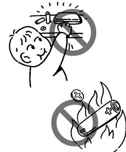
電池はショート、分解、加熱、加圧、火の中に入れるなどしないでください。液もれ、発熱、破裂などの原因となります。
