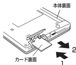
カードカバーを戻して、矢印の方向にスライドさせて確実に閉めます。
