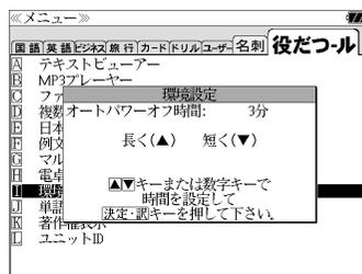
文字/数字入力キーで時間(分)を入力するか、**▽** / **△** を使って時間を設定します。時間を設定したら **決定** を押します。
