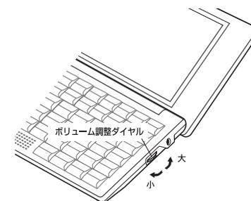
ボリューム調整ダイヤルを押すことにより、MP3データの再生/一時停止のボタンとして機能します。
