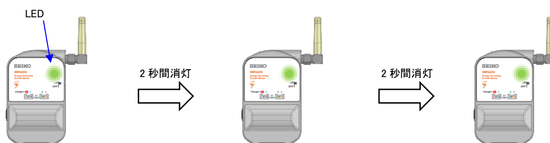
図 9 起動時の LED 発光フロー
