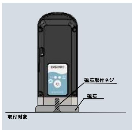
図7 専用磁石による固定
