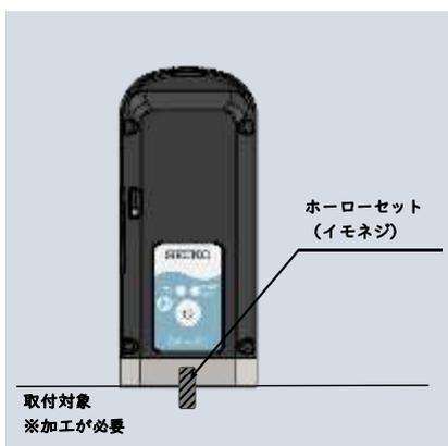
図6 付属ホーローセットによる固定
