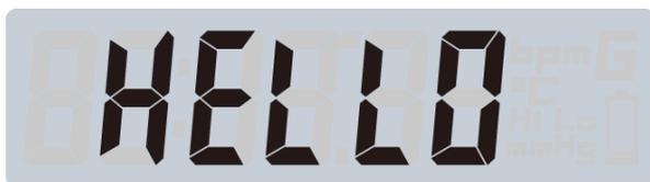
図 7 バイタルセンサ電源 ON 表示
