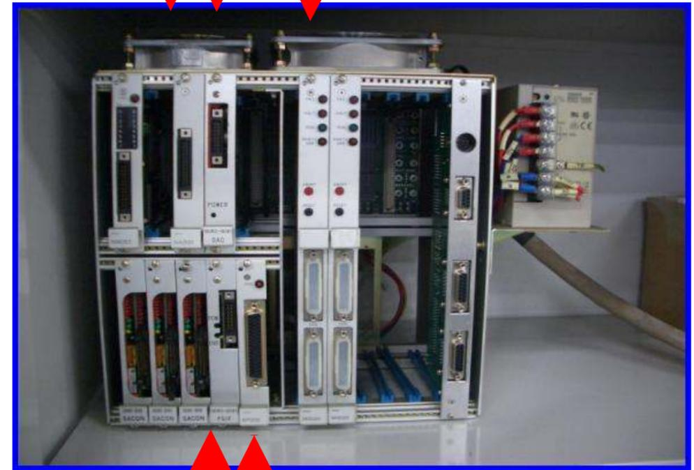
PCインターフェース基板 (型式: 3G8B3-BP000 : OMRON製)
