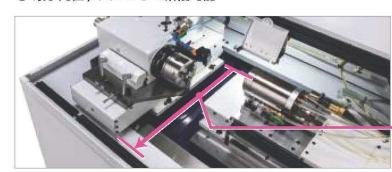
主軸テーブルストロークを従来機と 比較し33%拡大することにより ワークの脱着や機上測定などの操作 性が大幅に向上しました。
