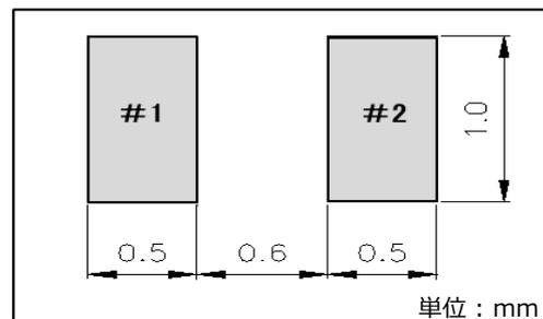
備考：回路基板設計の際は、水晶振動子搭載部（下面）に回路パターンを設けないでください。
