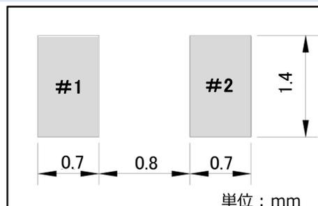
備考: 回路基板設計の際は、水晶振動子搭載部(下面)に回路パターンを設けないでください。
