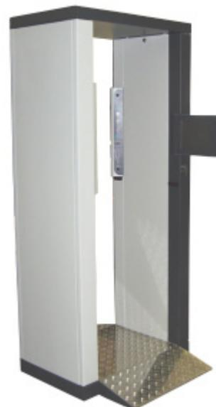
PM12は、8つの同一サイズの高感度ガンマプラスチックシンチレータ検出器を使用し、ポータルを通過する歩行者のガンマ線の汚染をモニタします。検出器は、側面に3つ、上下に1つずつ配置しています。PM12は、前モデルであるPM7の簡単操作がそのまま、基本操作ではキーパッドや複雑な表示は不要です。ユーザコントロールは、汚染検出後のアラーム音を消音するためのアラーム応答スイッチのみです。モニタの操作状況は、モニタフレームの両側に位置したシステムインジケータで確認できます。
