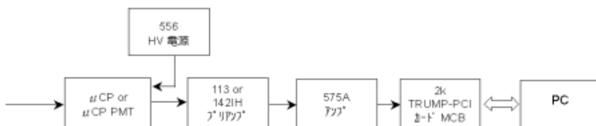
図 3. マイクロチャンネルプレート検出器、マイクロチャンネルプレート PMT を用いた波高 (電荷) 分析
