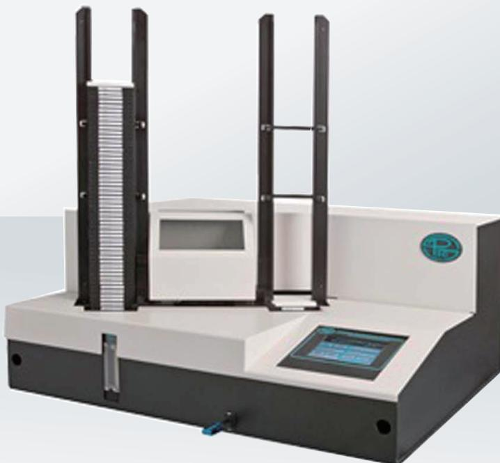
Protean社製WPC-1050は保健物理や放射化学アプリケーションユーザーのために設計されたガスフロー型の極低バックグラウンド $\alpha/\beta$ カウンタです。自動サンプルチェンジャを装備し、最大100個(オプション)の試料を自動的に測定します。検出器はガスフロー・プロポーションナル検出器を使用し、最大12通りの測定モードを記憶できます。
