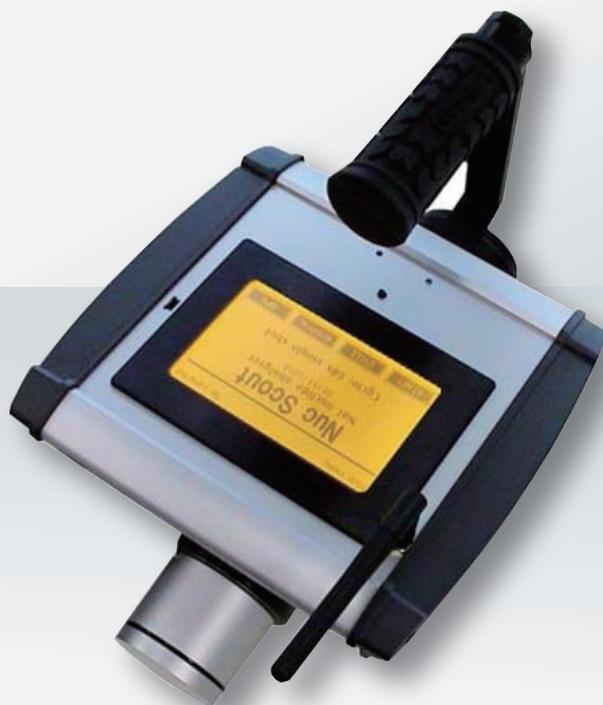
NucScout は、エネルギー補償と気温変化補正機能を持ったサーベイメータで、リアルタイムで線量当量率をモニタし、最大6核種毎の線量当量率と放射能を求めることができます。GPSを内蔵しており、GPSと連動した測定データを内蔵SDカードに保存します。オプションソフトにより、地図上に測定結果をマッピングすることができます。
