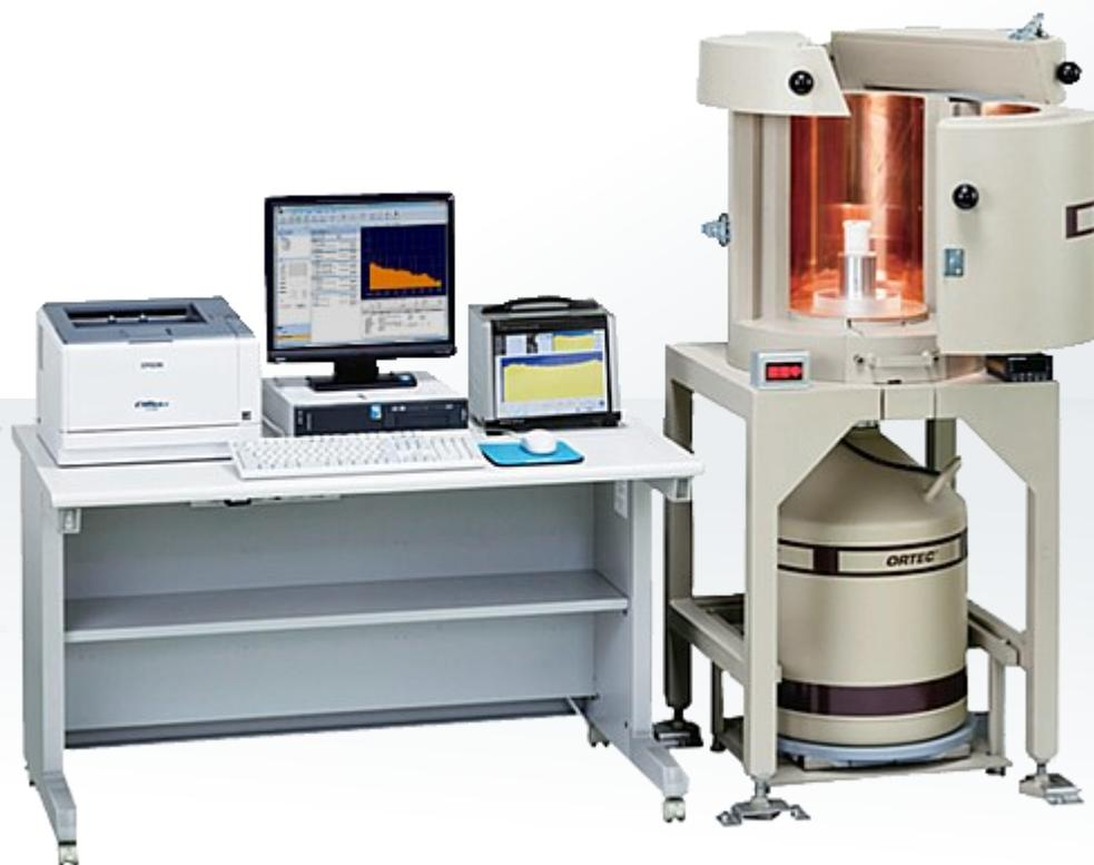
食品・環境放射能測定装置は、全国の食品メーカー様や検査機関、衛生研究所や電力会社様向け食品・環境ガンマ線核種分析を目的とした『ゲルマニウム半導体検出器を用いたガンマ線スペクトロメリーによる核種分析法』を可能とするシステムです。操作・解析プログラムに関しては、お客様と共に永年培ったノウハウと放射能測定法シリーズ 7「ゲルマニウム半導体検出器によるガンマ線スペクトロメリー」に対応したプログラムにより、容易な操作性と高度な信頼性をもたらします。
