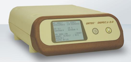
DSPECjr2.0は、ORTECによるDSPベースのガンマスペクトロメータです。ORTECのDSPECシリーズによって既に証明された性能に加え、最新のデジタルフィルタテクノロジー(低周波リジェクタ)を搭載。最速のデータ転送が可能になりました。
