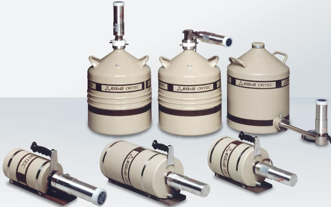
GEMシリーズは外側接触面がリチウム拡散、内側接触面はイオン注入で製造するクローズドエンド同軸型の検出器です。高純度Geの優れた品質により、最高のエネルギー分解能、ピーク対コンプトン比および1.33MeVでの優れたピーク対称性を有します。ストリームライン、PopTopどちらも供給可能です。
