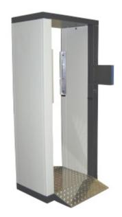
PM12は、8つの同一サイズの高感度ガンマプラスチックシンチレータ検出器を使用し、ポータルを通過する歩行者のガンマ線の汚染をモニタします。検出器は、側面に3つ、上下に1つずつ配置しています。PM12は、前モデルであるPM7の簡単操作がそのままで、基本操作ではキーパッドや複雑な表示は不要です。ユーザコントロールは、汚染検出後のアラーム音を消音するためのアラーム応答スイッチのみです。モニタの操作状況は、モニタフレームの両側に位置したシステムインジケータで確認できます。
