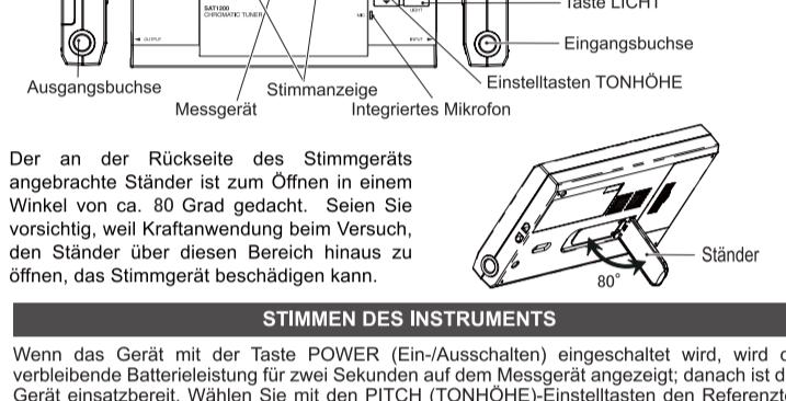
Der an der Rückseite des Stimmgeräts angebrachte Ständer ist zum Öffnen in einem Winkel von ca. 80 Grad gedacht. Seien Sie vorsichtig, weil Kraftanwendung beim Versuch, den Ständer über diesen Bereich hinaus zu öffnen, das Stimmgerät beschädigen kann.
