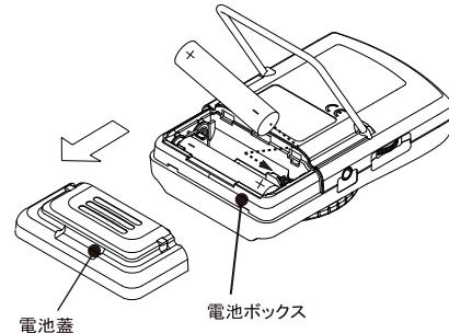
パワースイッチをOFFにします。本機の裏側にあるスタンドを開き、電池蓋を左図の矢印の向きにスライドさせて外し、消耗した電池を2本とも取り出します。電池ボックス内の極性表示と同じ向きで新しい2本の電池をマイナス側からセットして電池蓋を取り付けます。取り付けが完了したら、電源をONにして正常に動作することを確認してください。
